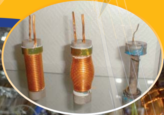
Un électroaimant alimenté par un courant de plus en plus intense finit par exploser sous l'effet de la pression magnétique (de gauche à droite sur l'image) © LNCMI
